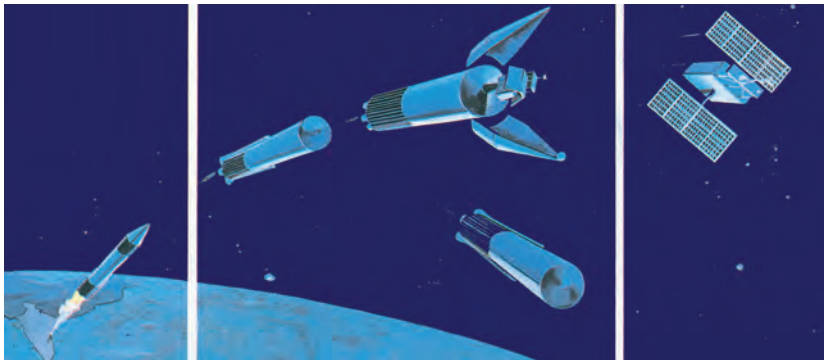
रॉकेट का प्रक्षेपण रॉकेट का पृथ्वी पर गिरना उपग्रह का कक्षा में प्रवेश चित्र 1.4: मानव-निर्मित उपग्रह
